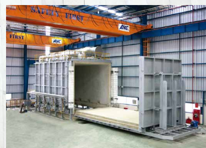
台車式対流型熱処理炉 開口時
