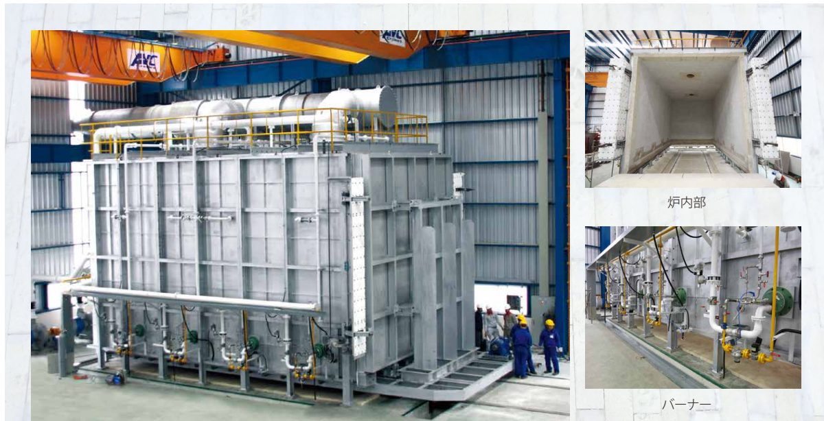
台車式対流型熱処理炉 閉口時
